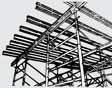
Las vigas de aluminio ALJ de Safway® se pueden usar como viguetas y como zancas.
